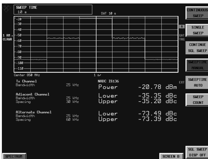
Рис. 2-40 Мощность смежных каналов от спектра модуляции и спектра переходных процессов
