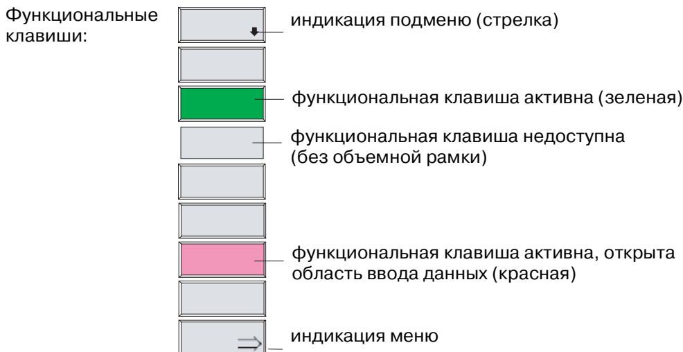
Рис. 3-5 Устройство области функциональных клавиш
